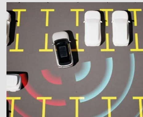
System ostrzegania przed kolizją podczas cofania (RCW)
