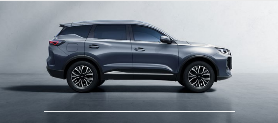
Długość całkowita: 4553 mm, rozstaw osi: 2670 mm
