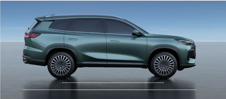
Długość całkowita: 4725 mm, rozstaw osi: 2710 mm
